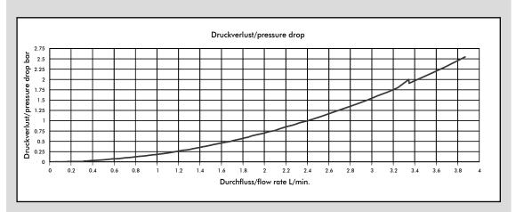
Getestet mit Wasser, max. Druck: 3.3 bar / Tested with water, max. pressure 3.3
