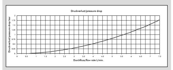
Getestet mit Wasser, max. Druck: 3.3 bar / Tested with water, max. pressure 3.3 bar
