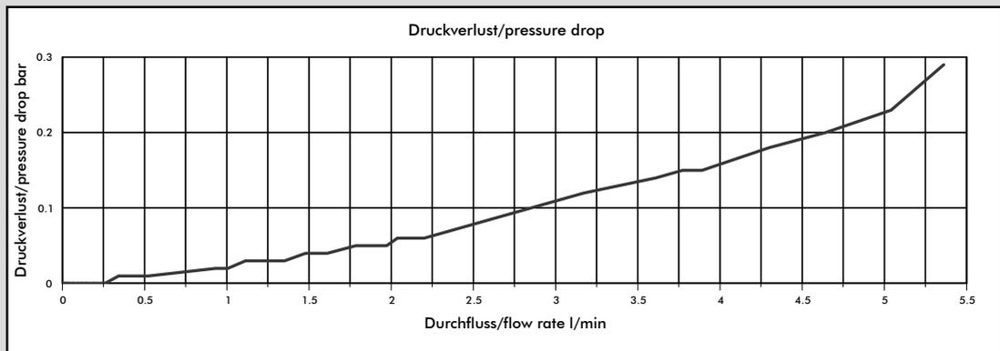
Medium für diese Linearitäts- und Druckverlust Kurven: Cola Sirup (ca. 24 centistokes).
